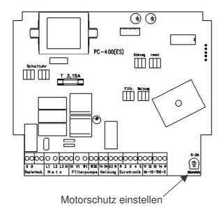
Die Drehstrom-Filterpumpe wird durch einen elektronischen Motorschutz vor Beschädigung durch Überlastung geschützt. Dazu muß der Motorschutz auf den Nennstrom der Filterpumpe (siehe Typenschild der Pumpe) eingestellt sein. Falls der Nennstrom der Filterpumpe nicht bekannt ist, kann der Motorschutz nach folgendem Verfahren eingestellt werden:
