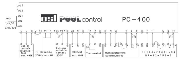
Die werksseitig eingefügte Brücke zwischen den beiden mit *Th* bezeichneten Klemmen muß bei Anschluß eines Sicherheits-Temperaturbegrenzers entfernt werden. Erfolgt kein Anschluß, dann muß sie eingeschraubt bleiben.
