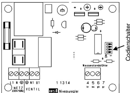
Im Auslieferungszustand befinden sich die Schalter 1,2,3 und 4 in Stellung ON. Das bedeutet eine Zeitüberwachung von 120 Minuten.
