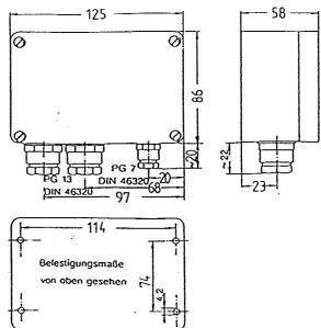
Die Elektronik und die Niveausonde arbeiten mit einer Sicherheits-Kleinspannung von 7V. Der Aufbau der Regelung entspricht den einschlägigen VDE-Vorschriften.
