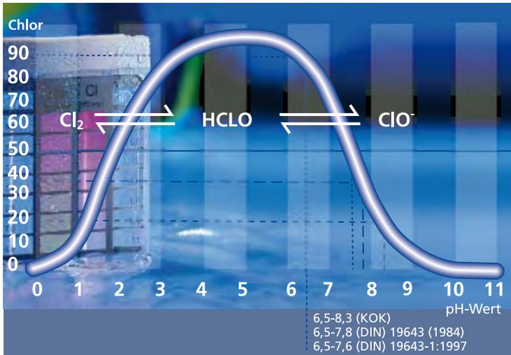
Die entkeimende Wirkung des Chlores und der chlorabspaltenden Präparate sinkt somit drastisch mit zunehmendem pH-Wert des Schwimmbeckenwassers, aus diesem Grunde ist der pH-Wert-Messung und -Regulierung größte Bedeutung beizumessen.
