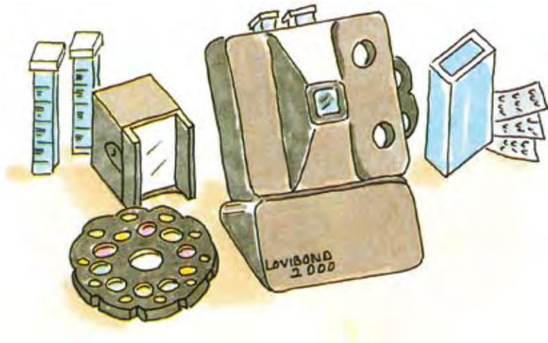
Die erforderliche Genauigkeit der Messergebnisse kann nur bei Verwendung hochwertiger Farbscheiben sichergestellt werden. Ausschließlich Farbstandards aus Glas sind licht- und chemikalienbeständig sowie hoch kratzfest. Lovibond®-Farbstandards bestehen aus „durch und durch“ gefärbten und plan geschliffenen Gläsern.
