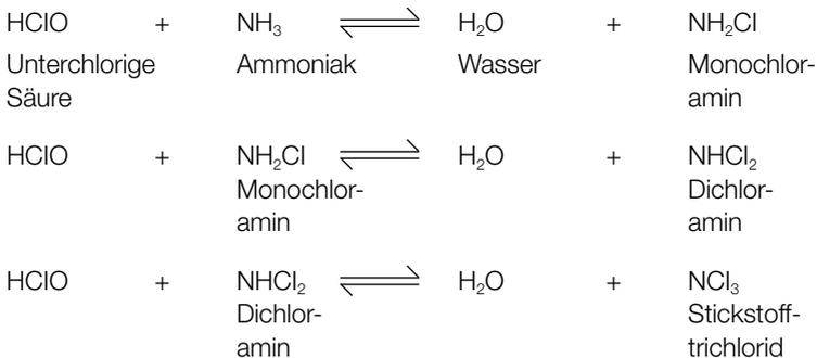
Durch einen **weitere Zugabe von Chlor** können diese Verbindungen abgebaut werden, etwa nach der Gleichung:
