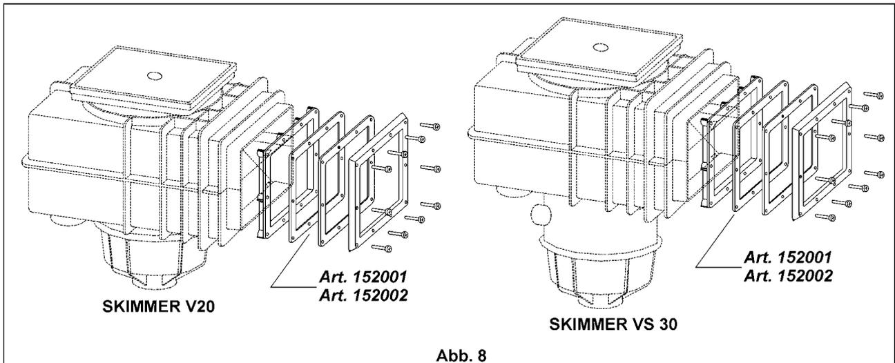
Eine Flanscheinheit besteht aus Flanschrahmen, hochbeständigen EPDM-Dichtungen, 10 Schrauben V4A M6x22 und Kunststoffflansch ABS weiß Art. 152001, bzw. Niroflansch Art. 152002. (Abb. 9)
