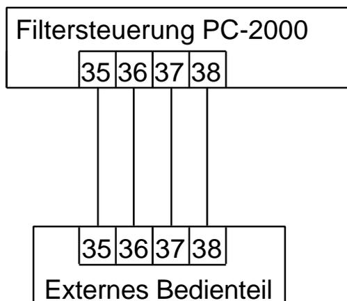
Zur Verbindung mit der Filtersteuerung dient eine 4adrige Telefonleitung (Art.Nr.3100000500) mit einer Länge von maximal 50m. Eine Verlegung der Verbindungsleitung in der Nähe von Netzleitungen ist zu vermeiden, um mögliche Störeinflüsse auszuschließen.
